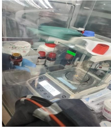
Gambar 3.5 Merupakan proses penimbangan bahan-bahan yang akan digunakan pada pembuatan sampel perovskite \text{FAPbI}_3
